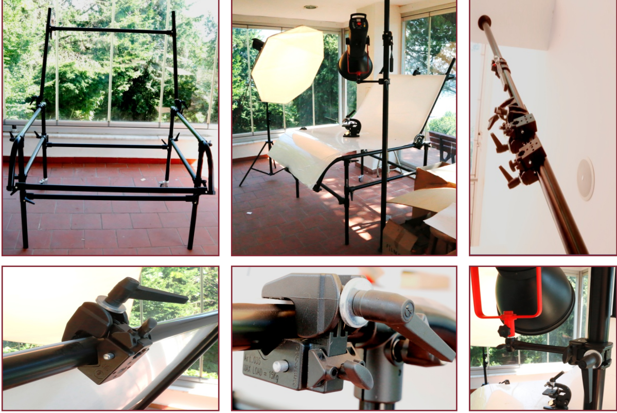
Resim 1. Yukarıdan aşağıya soldan sağa doğru: Still Life (İng. Ölü doğa, natürmort.) masası (Platformszus çerçeve ve fonksiyonel durumu). Autopole (Boyu ayarlanabilir direk) ve çeşitli clampler (kıskaç) Soldaki ışık kaynağı tripota (üç ayak) sağdaki ışık kaynağı (flash) ağır olduğundan autopole sabitlenmiştir.
