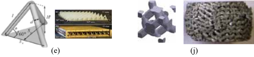
Şekil 2. Birim hücre ve üretilen köpük soğutucular [40-55].
